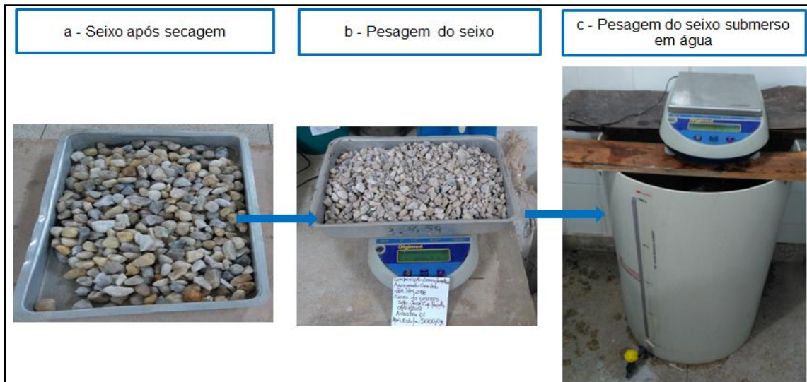
Figura 22. Detalhe do ensaio da massa específica do seixo
