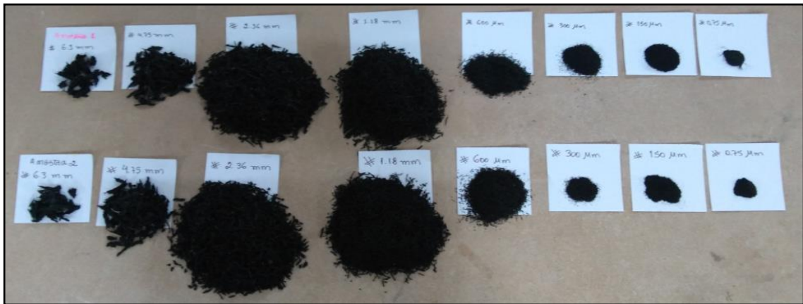
Figura 20. Massas retidas em cada peneira do resíduo de borracha
