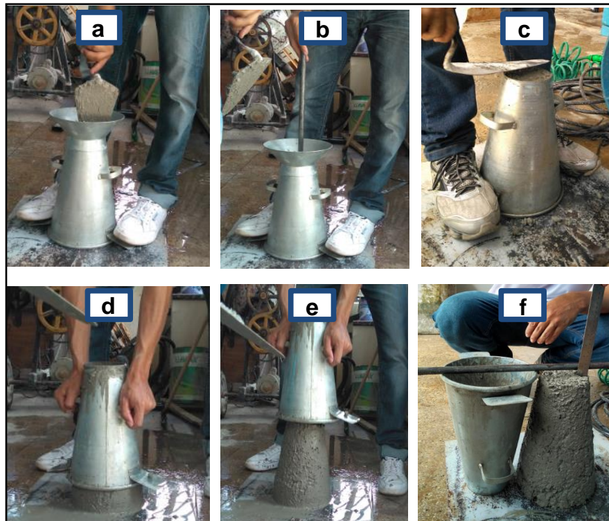
Figura 25. Procedimento do ensaio pelo abatimento do tronco do cone
