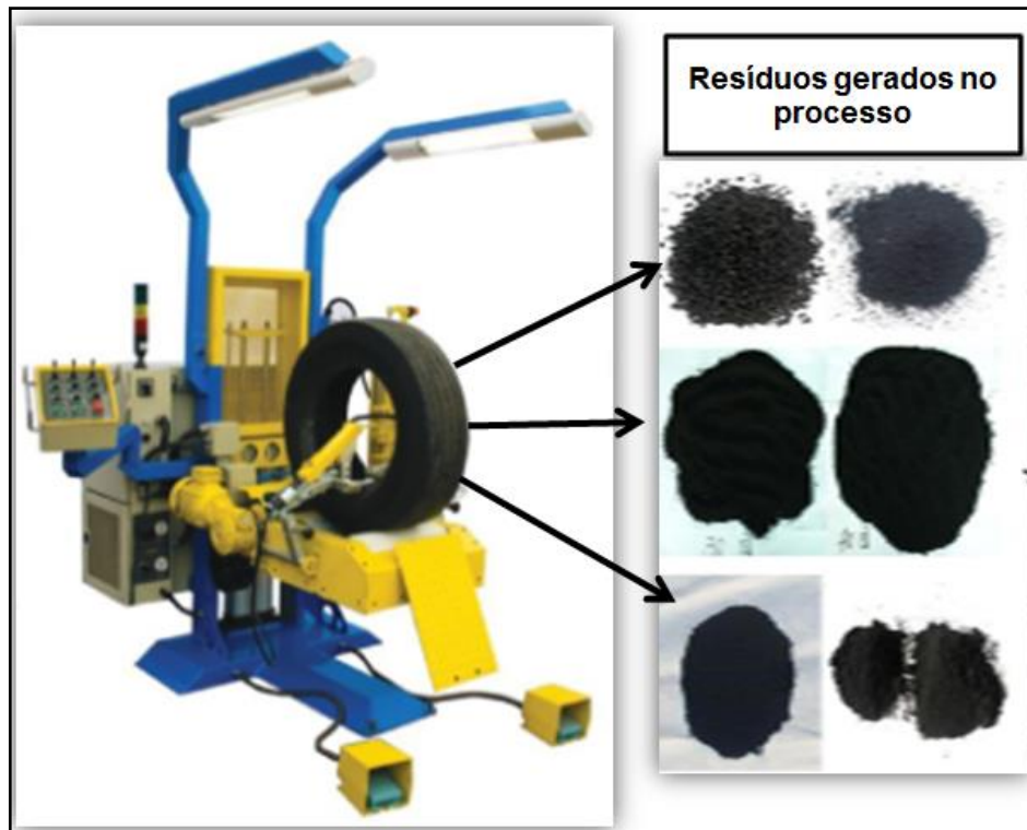
Figura 11. Processo de recauchutagem.
