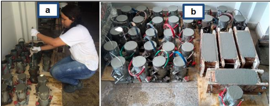
Figura 26. Moldagem (a), Aparência final do concreto (b).
