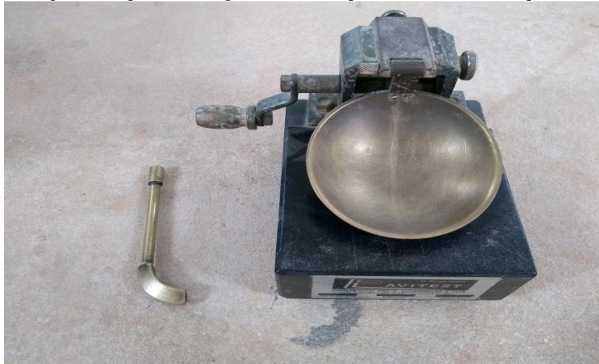
Figura 8 – Aparelho Casagrande utilizado para obter o limite de liquidez.
