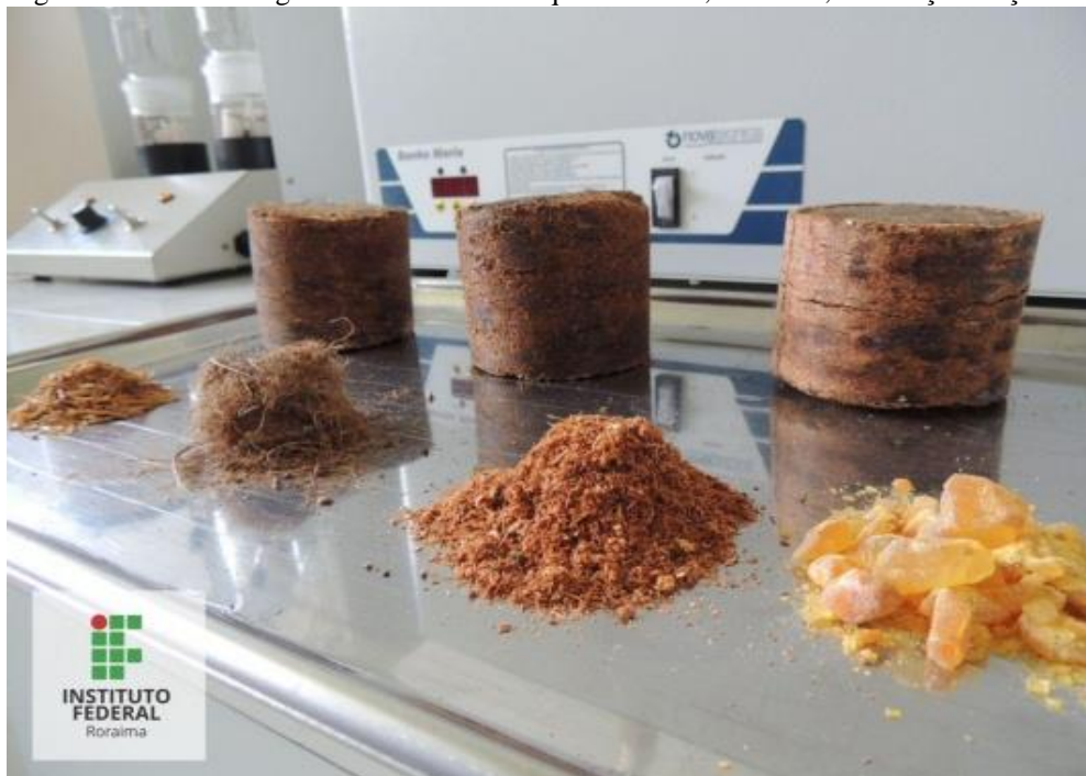
Figura 6 - Lenha ecológica em formato de briquete oriunda, inclusive, de caroço de açaí
