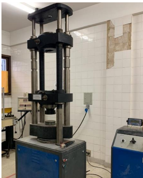
Figura 17 - Prensa hidráulica para ensaios de compressão axial
