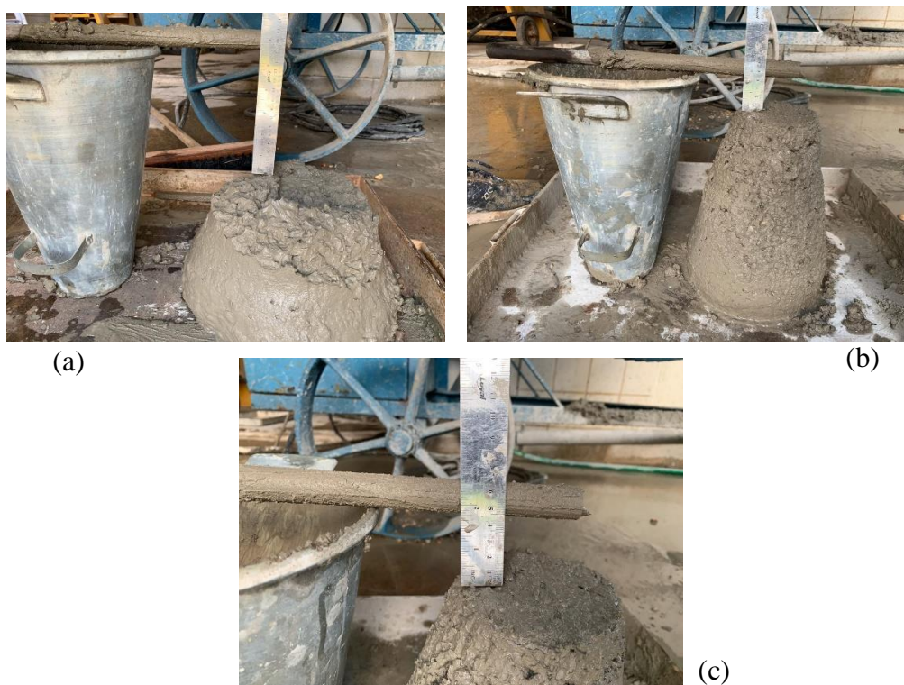
Figura 18 - Ensaio de abatimento do concreto de referência
