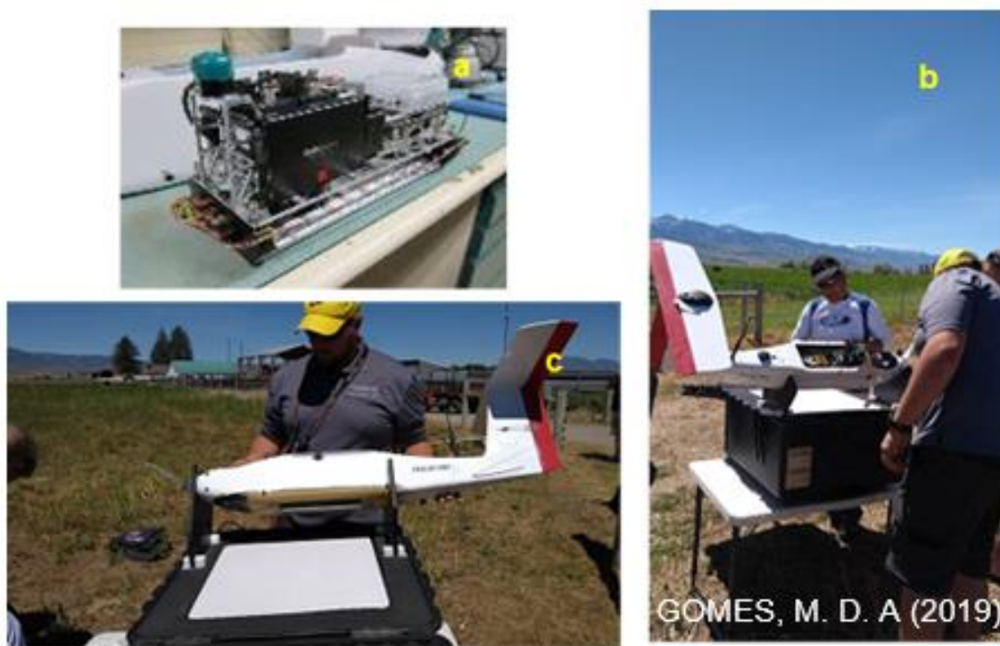
Figura 11 – Carga útil (a), conexão da carga útil à Aeronave AggieAir (b) e Aeronave AggieAir (c)
