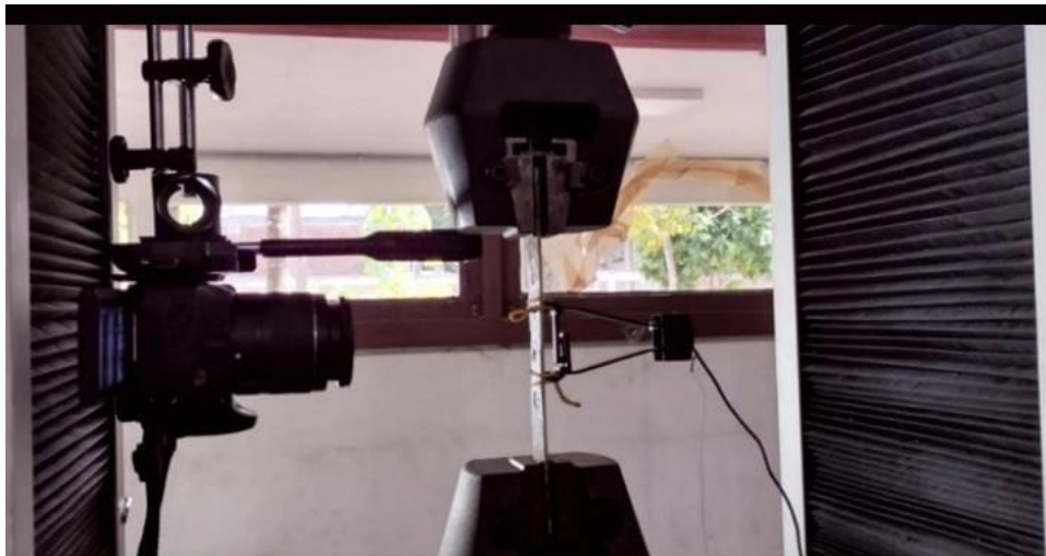
Figura 24 - Instalação do Extensômetro
