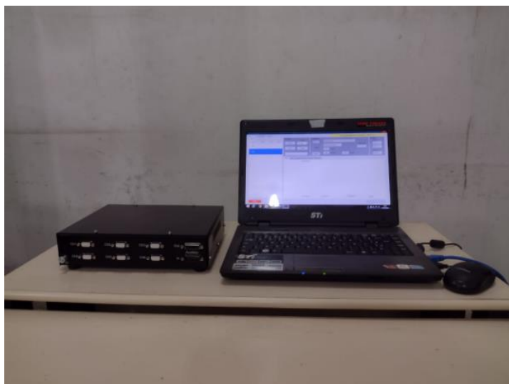
Figura 29 – Módulo de aquisição de dados com computador conectado
