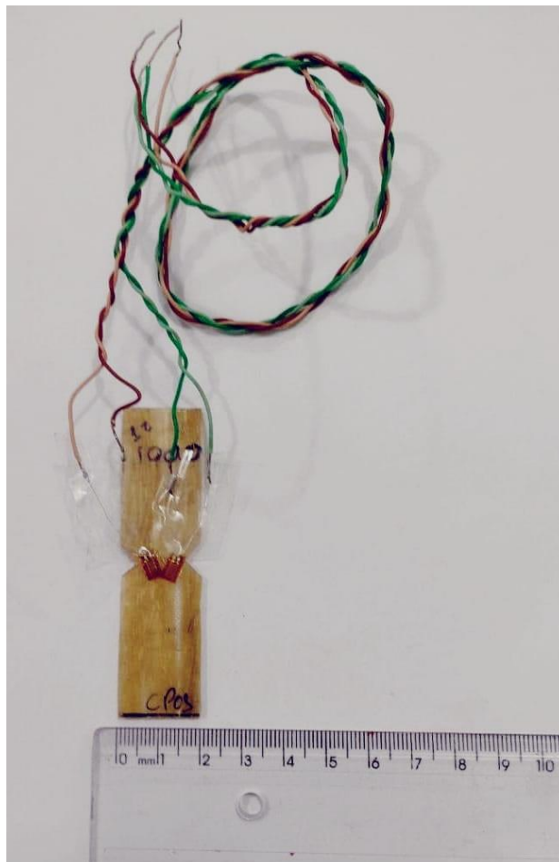
Figura 26 – Corpo de Prova com Strain Gauge
