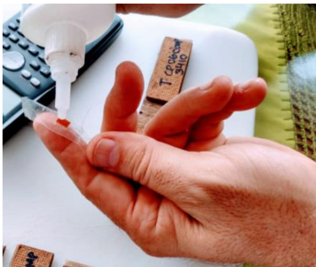
Figura 25 - Colagem de Strain Gauge
