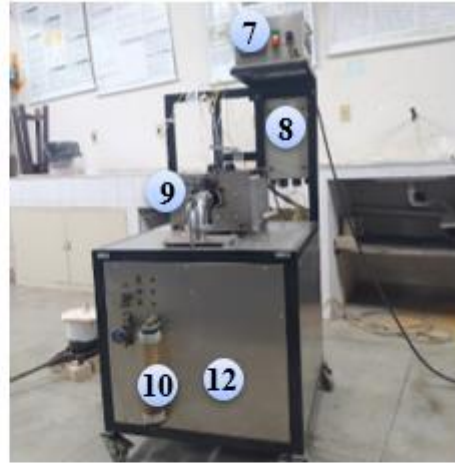
Figura 3.5: Representação esquemática do equipamento de solidificação horizontal.
