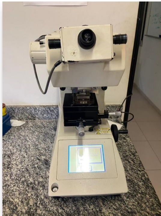
Figura 3.8: Microdurômetro modelo SHIMADZU HMV-2.
