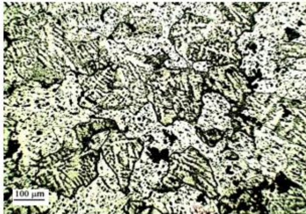
Figura 4.12: Microestruturas da liga Al3%Cu0,5%Nb após tratamento térmico T6 com Solubilização de 3 Horas a 495 \pm 2^\circ\text{C} e envelhecimento artificial de 1h.
