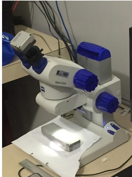
Figura 3.9: Microscópio Estereo Zeiss modelo Stemi Dv4.
