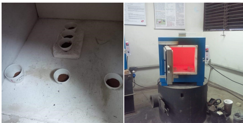
Figura 13 - a esquerda: conjunto de cadinhos acomodados no forno. A direita: visão geral do forno do Laboratório de Tratamento Térmico do Instituto Federal do Pará.
