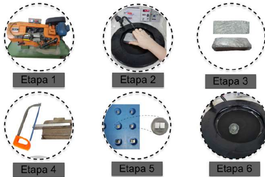
Figura 3.7 - Sequência realizada para preparação dos corpos de prova.
