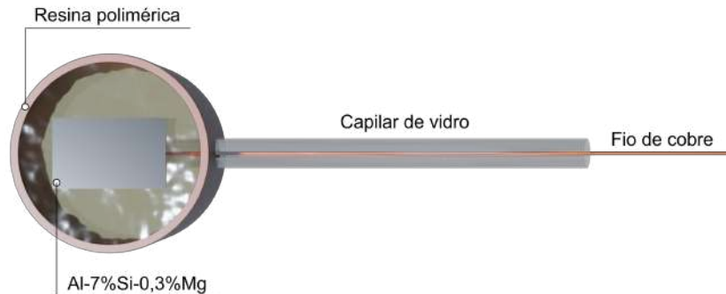
Figura 3.20 – Esquema com detalhamento do eletrodo de trabalho confeccionado.
