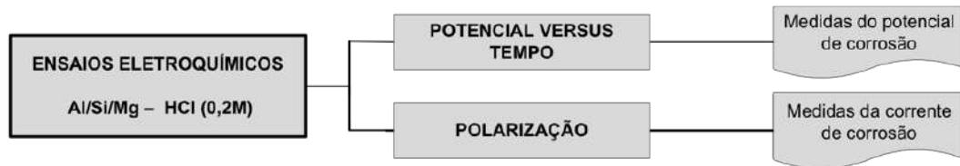
Figura 3.18 – Fluxograma representando os ensaios eletroquímicos realizados.
