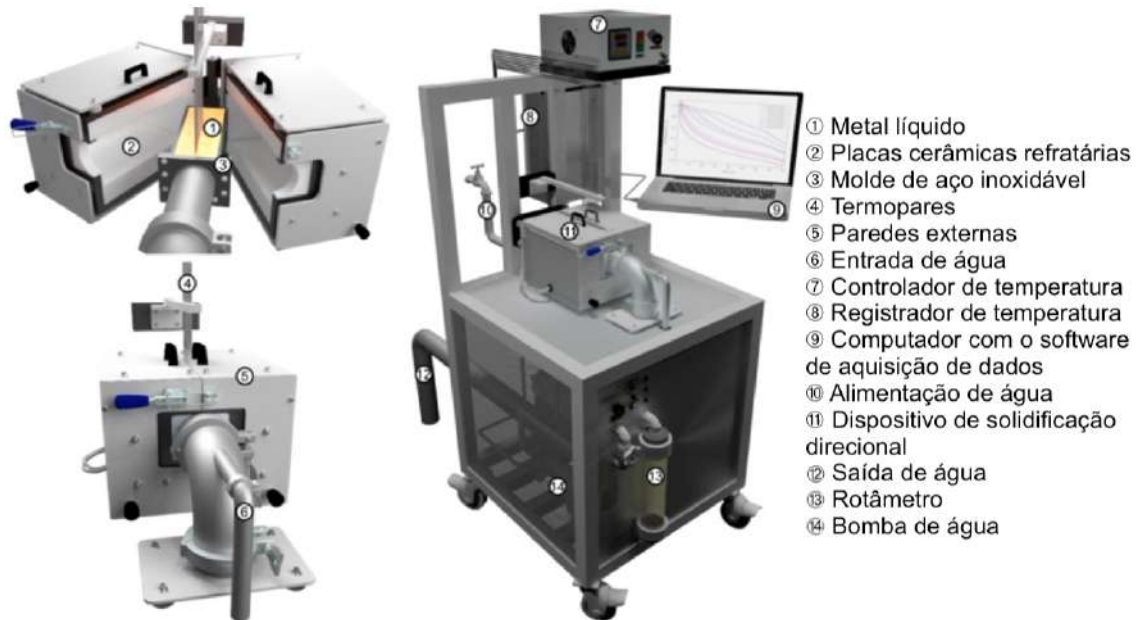
Figura 3.3 - Forno de solidificação horizontal.
