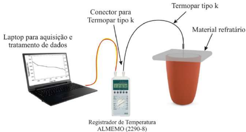
Figura 3.2 – Processo experimental de obtenção da curva de resfriamento.
