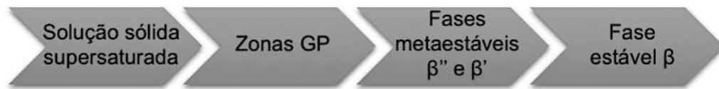
Figura 2.11 - Esquema representativo da precipitação da fase \beta -Mg 2 Si durante o envelhecimento.
