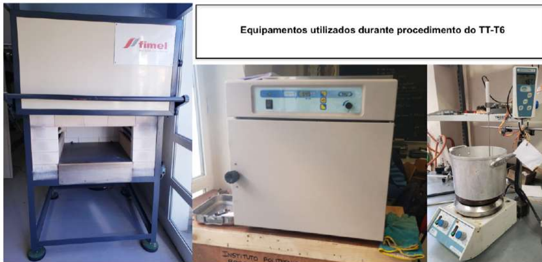
Figura 3.16 – Equipamentos utilizados para realização do procedimento de tratamento térmico no laboratório de resistência dos materiais do IPB.
