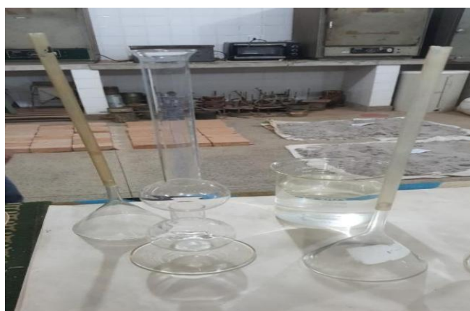
Figura 3.7 - Materiais para o ensaio de Massa Específica do Agregado Miúdo.
