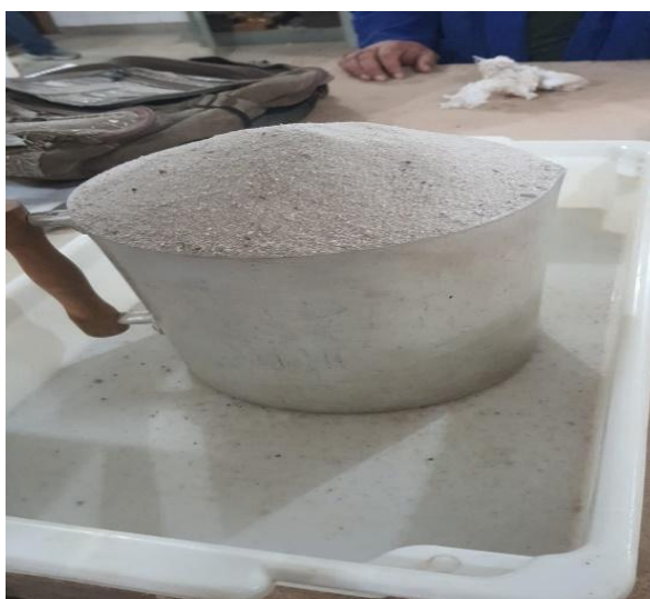
Figura 3.8-Materiais para o ensaio de Número de Vazios do Agregado Miúdo.
