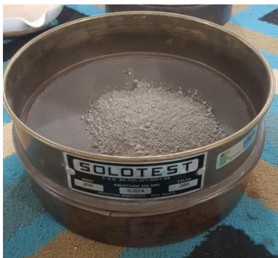
Figura 3.1 - Materiais para o ensaio de Finura do Cimento CP II E 32.
