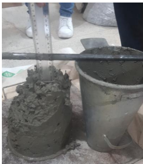
Figura 3.13 - Realização do Ensaio de Slump Test.
