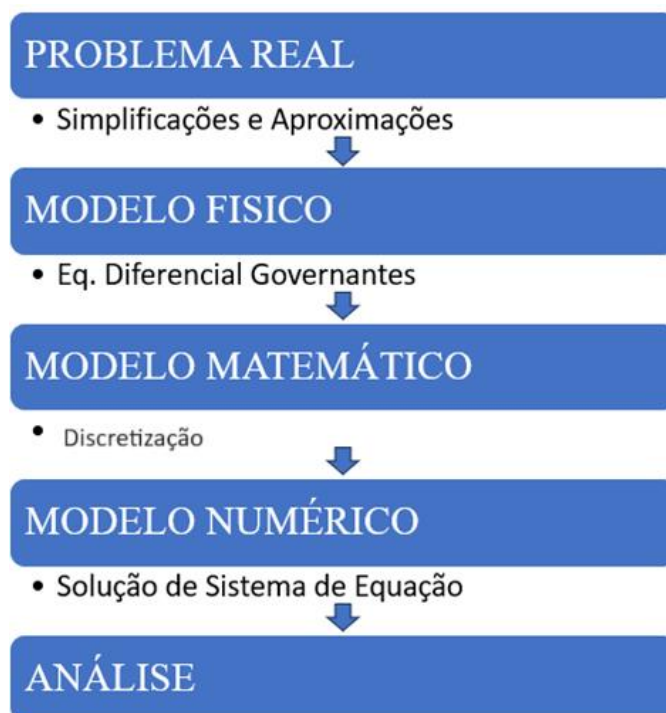
Figura 3.19 - Fluxograma de métodos de elementos finitos
