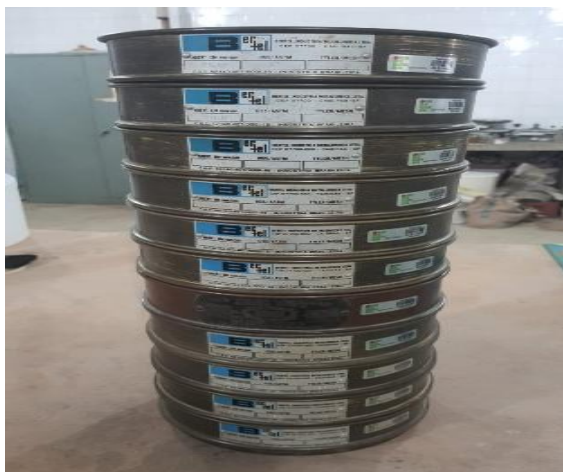
Figura 3.3 - Peneiras utilizadas no ensaio de granulometria do agregado graúdo.
