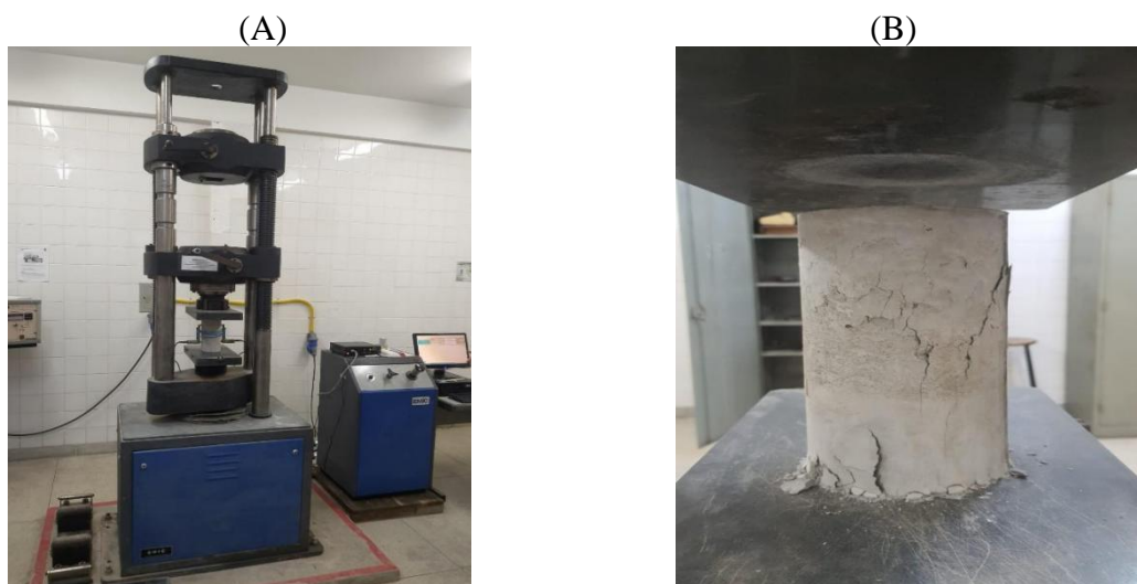
Figura 3.14 - (A) Prensa Hidráulica – mod: EMIC e (B) Corpo de prova.
