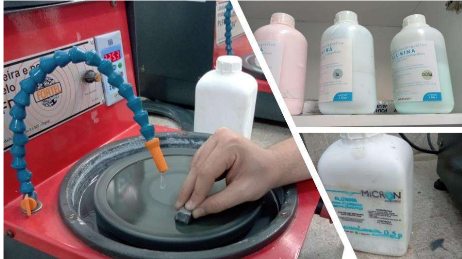
Figura 3.9 – Registro fotográfico do momento do lixamento e polimento das amostras para análise microestrutural
