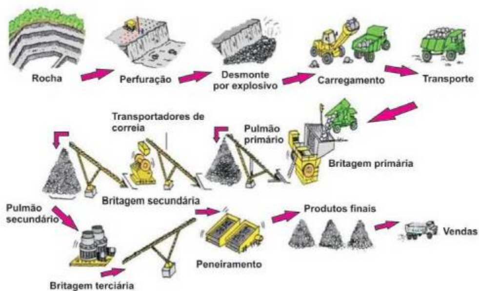
Figura 1 - Circuito de britagem aplicado em pedreiras.
