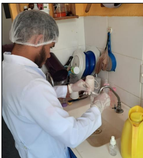
Figura 2: Procedimento de coleta de amostra de água nos residenciais de estudo para análise microbiológica.
