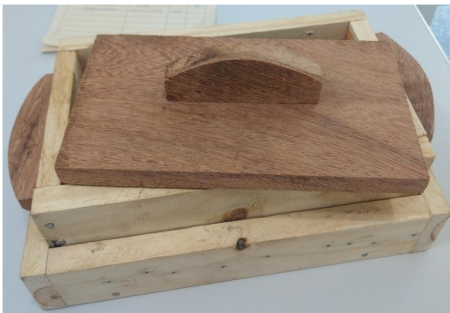
Figura 12 – Caixa de prensagem dos tijolos de solo-cimento
