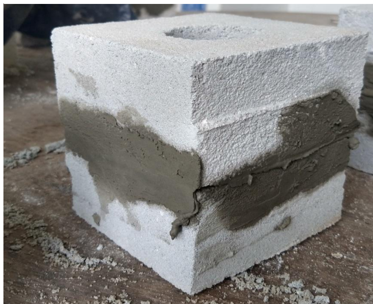
Figura 17 – Corpo de prova preparado para o ensaio de compressão
