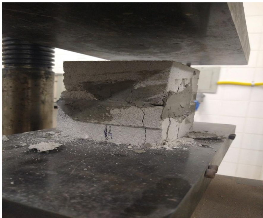
Figura 20 – Corpo de prova rompido
